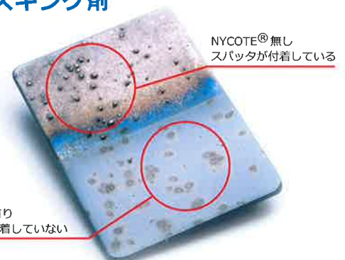
スパッタを飛散させた金属板 (写真)
